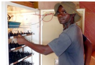
Att bygga en äggkläckare av ett gammalt kylskåp är ett effektivt sätt att skapa en rymlig inkubator. Isoleringen i väggarna hjälper till att hålla en jämn temperatur.
